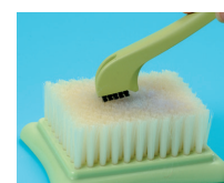
Les dents repoussent les bris de feutre à travers les poils.
